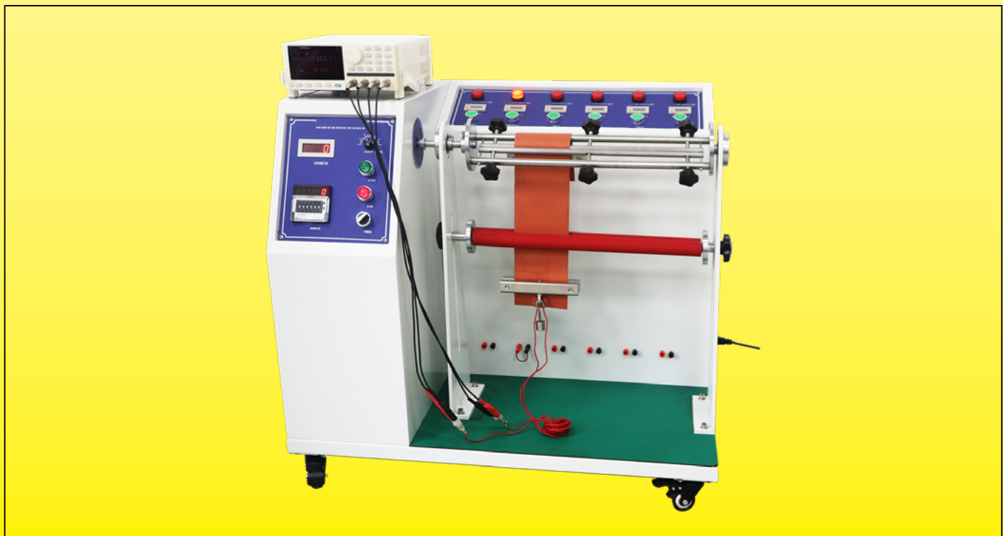
Riscaldatore in silicone flessibile durante il test di flessione
