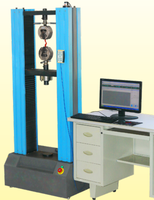
Apparecchiatura per il test di resistenza allo strappo
