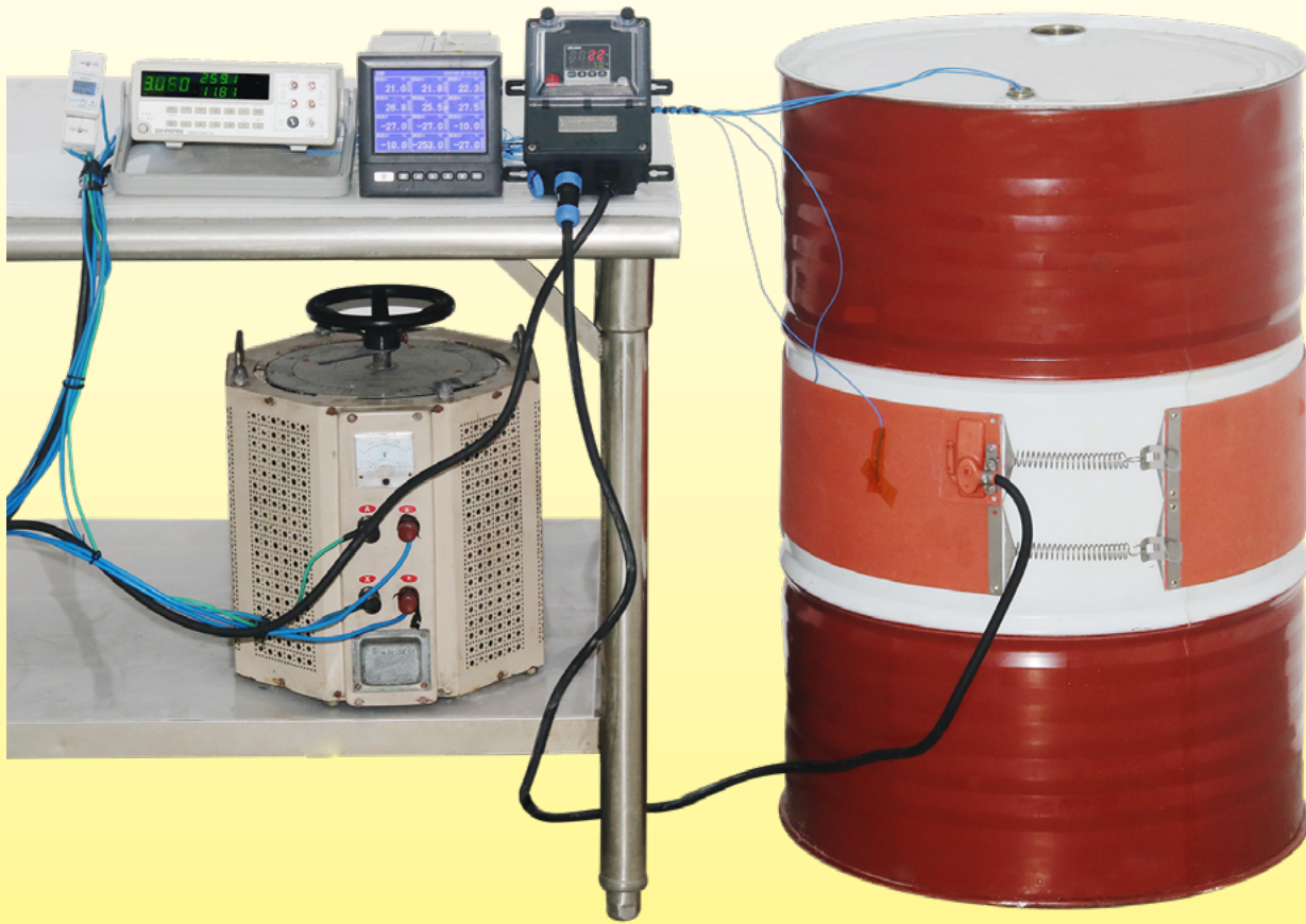
Variatione della temperatura nel tempo di un fusto metallico da 220 litri, riempito d'acqua, riscaldato da un nastro riscaldante in silicone largo 200 mm, senza isolamento termico, potenza 1500 W (carico superficiale 0.5 W/cm 2 ).
