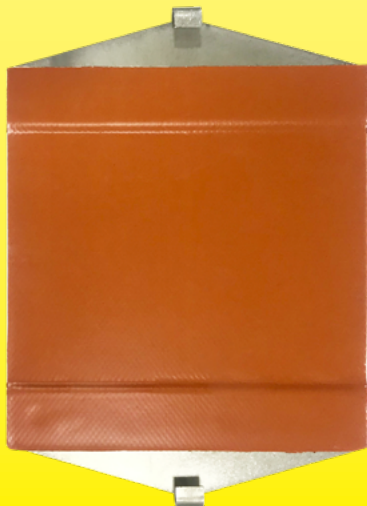
Campione per il test della forza di strappo
